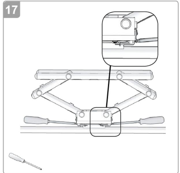
レーザーの両側のねじを調整することによってディスプレイの回転動作の速度を調整することが可能です。
