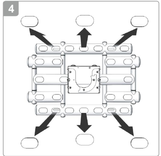
付属の穴あけ型紙を、設置したい高さに水平に仮止めし、上側に3箇所、下側に3箇所、計6箇所にマーキングしてください。(ねじ止め箇所は、6箇所を推奨します。)
