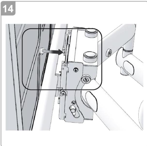
クロスバーをレーザーに取り付け、6mmのセーフティノブを再度取り付けてください。
