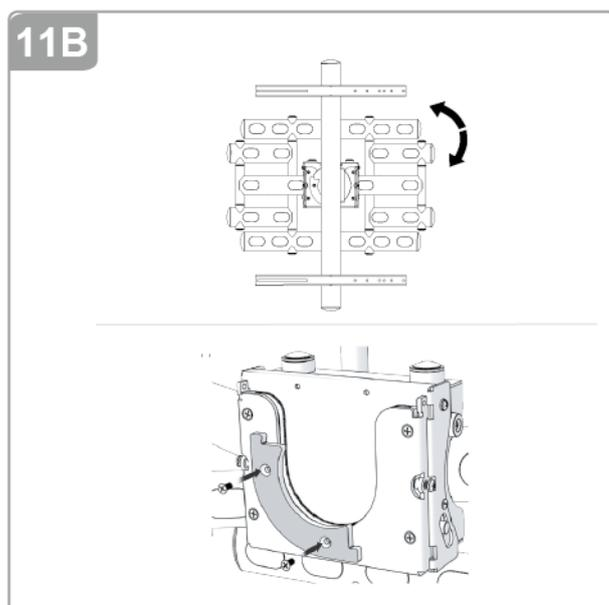
付属ねじを4個使用し、ブラケットにクロスバーを固定してください。
