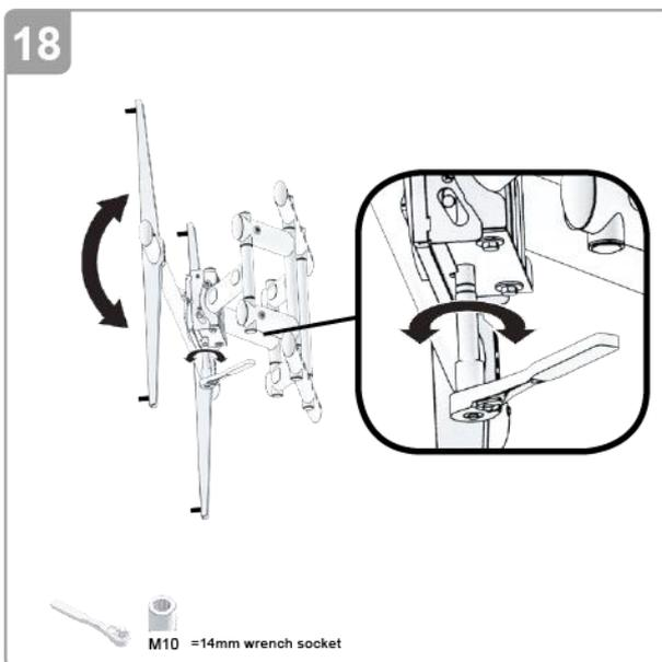
PFW6855は、14mmソケットを使用してチルト機能を調整できるロード・オフセット調整機能を備えています。
