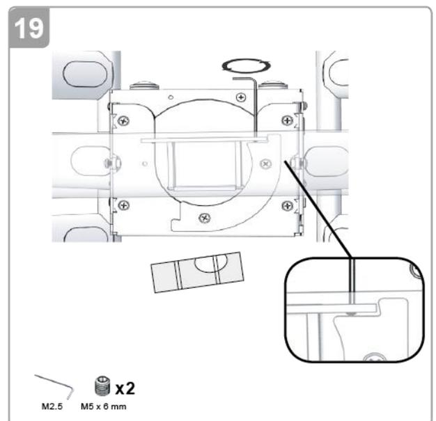
2.5mm六角レンチを使用し、回転停止バー両側のM5x6mmの調整用六角ネジを調整することにより、任意の回転角度で固定が可能です。
